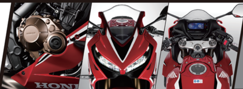
承襲CB系的直列四缸引擎 承襲CBR系列雙鷹眼頭燈 儀表可顯示檔位、時速、轉速與油量等資訊
